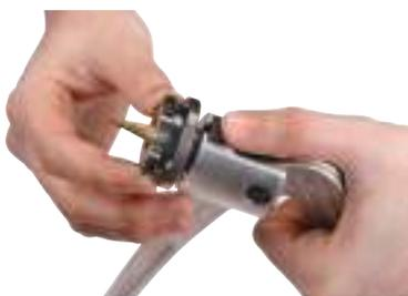
Ступенчатая регулировка расширения труб
