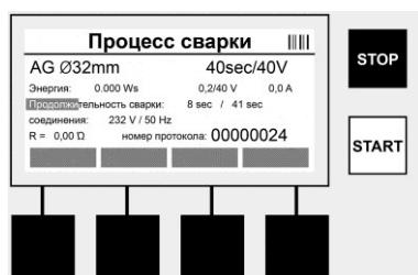
В процессе сварки все важные данные отображаются на дисплее. Процесс сварки контролируется на протяжении всего времени сварки в соответствии с параметрами, заданными в коде муфты.
