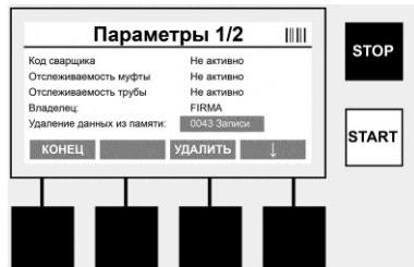
Устройство автоматически сохраняет до 2 000 сварок. Если 2 000 ячеек памяти заполнены, устройство выводит на стартовый экран соответствующее предупреждение. Следующие 47 сварок сохраняются в области переполнения.
