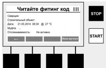
Сосканировать код муфты с помощью устройства считывания штрихкодов. Если устройство считывания штрихкодов повреждено или код муфты невозможно считать, его можно ввести вручную. Для этого необходимо нажать клавишу >ВВОД ВРУЧНЮ< (см. также раздел «Ввод»).
