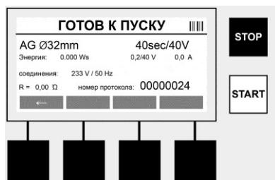
Диаметр ..... Диаметр трубы в соответствии с кодом муфты
