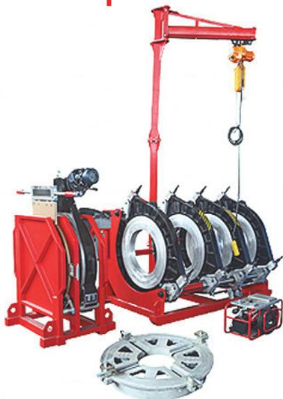
Машина для стыковой сварки с гидравлическим приводом пластиковых труб из ПЭ, ПП и ПВХДФ диаметром от 630 до 1000 мм.
