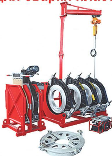
Машина с гидравлическим приводом для стыковой сварки пластиковых труб из ПЭ, ПП и ПВХДФ диаметром от 450 до 800 мм
