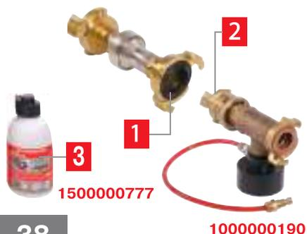
**1** Редуктор давления должен быть установлен на стороне входа воды промывочного компрессора ROPULS. Это поддерживает входящее давление подачи пресной воды постоянным на уровне 2 бар
